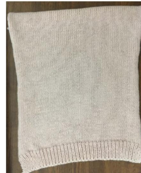
Hình 1. Mẫu vải thí nghiệm dệt trên máy SIR 122 của Shima Seiki
